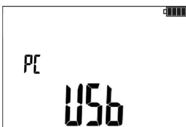
Подключите кабель от порта USB компьютера к разъему USB измерителя. На дисплее прибора отобразится сообщение **USB**.
