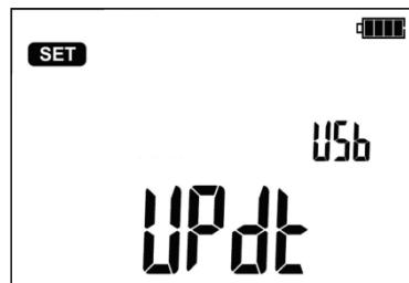
Клавишами  $\leftarrow$  и  $\rightarrow$  перейти к следующему экрану обновления программного обеспечения измерителя: **UPdt**.
