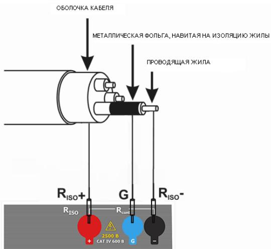
Таким же способом подключается разъём **G** при измерении сопротивления между двумя жилами к третьей, не участвующей в процессе измерения.
