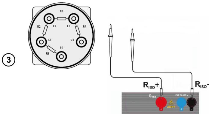
Подключите измерительные провода к разъёмам СК-1.
