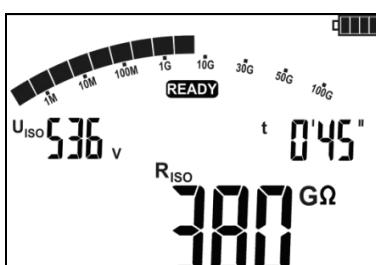
После окончания измерения сравните результат на дисплее с выставленным значением симулятора СК-1 согласно собранной схеме.
