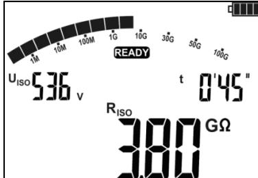
После окончания или прерывания измерения, на дисплее можно считать результат. Отображаются результаты всех измерений, которые были проведены (также в случае прерывания измерения, например, по истечении 60 сек.). Если прибор переключился в состояние готовности, то результат измерения можно восстановить на экран клавишей **ВВОД**.
