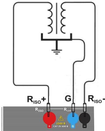
При измерении сопротивления между жилой кабеля и экраном, влияние поверхностных токов (особое влияние оказывают при сложных погодных условиях) устраняют соединением кусочка металлической фольги, навитого на изоляцию измеряемой жилы, с разъёмом **G**.
