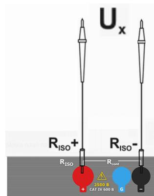
Подключить прибор к источнику напряжения.
