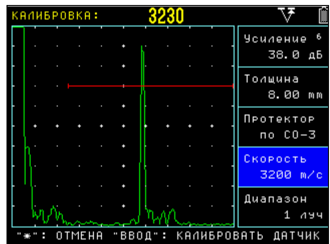
рис.3-9 Калибровка скорости в образце
