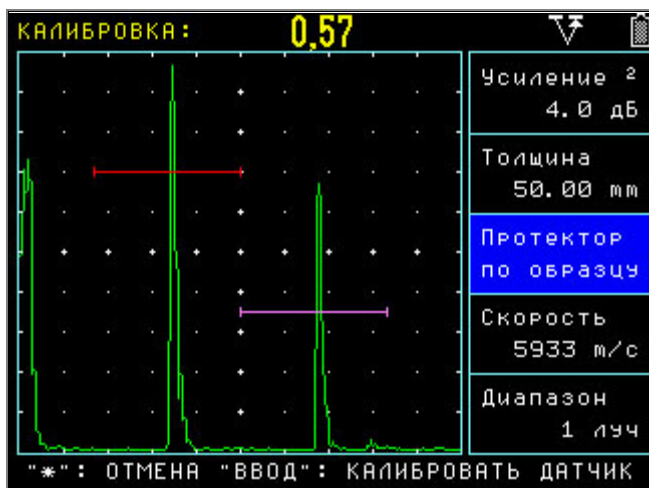
рис.3-6 Экран калибровки прямого преобразователя по плоскопараллельному образцу толщиной 50мм
