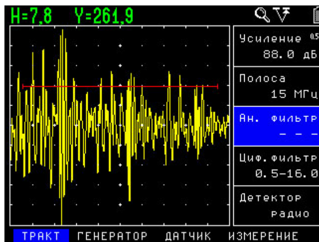
а) Сигналы переотражений на глубине 260 мм без применения фильтров
