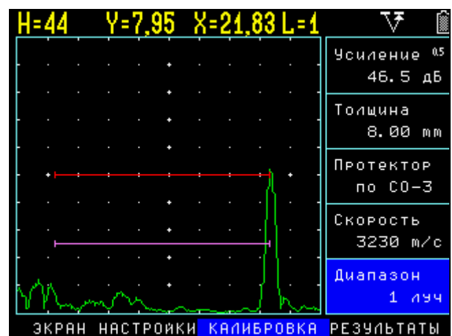
а) Калибровка диапазона для контроля прямым лучом
