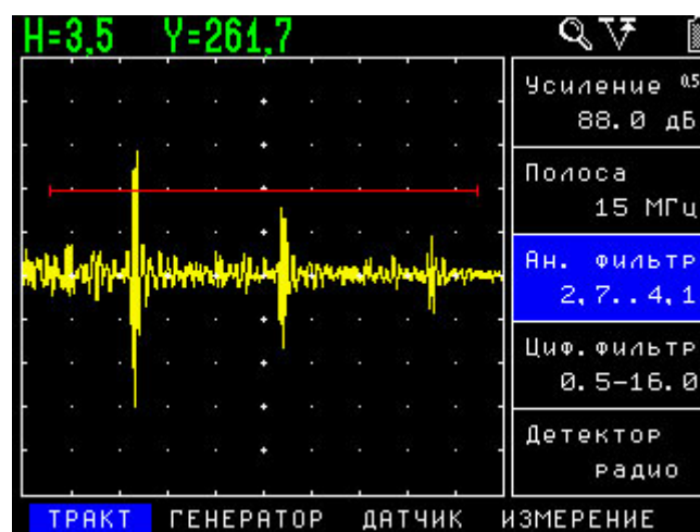
б) Сигналы после включения аналогового фильтра 2,7-4,1 МГц.
