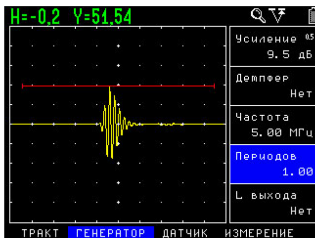
а) Стандартный преобразователь 5МГц. Возбуждение 1 периодом частоты
