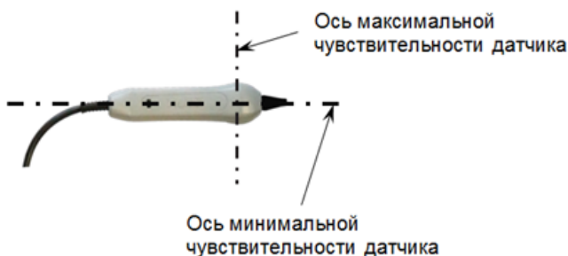
Рисунок А.2. Оси чувствительности датчика MED-127.
