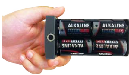
б) Вставить батареи в отсек, соблюдая полярность
