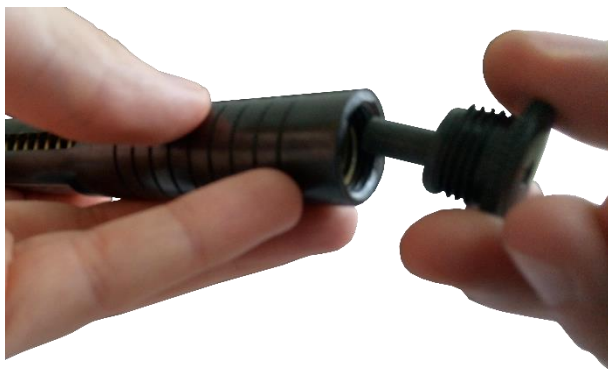
Рисунок 2.3 – Вкручивание заглушки с индентором
