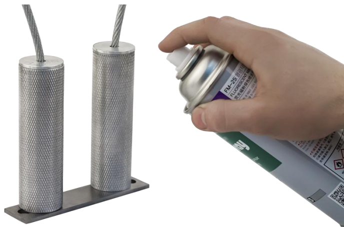
Рисунок 2.1 – Нанесение суспензии на контролируемый участок
