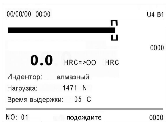
Рисунок 2.5 – Дисплей прибора в момент окончания установки предварительной нагрузки
