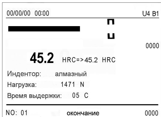
Рисунок 2.6 – Дисплей прибора после завершения цикла измерения
