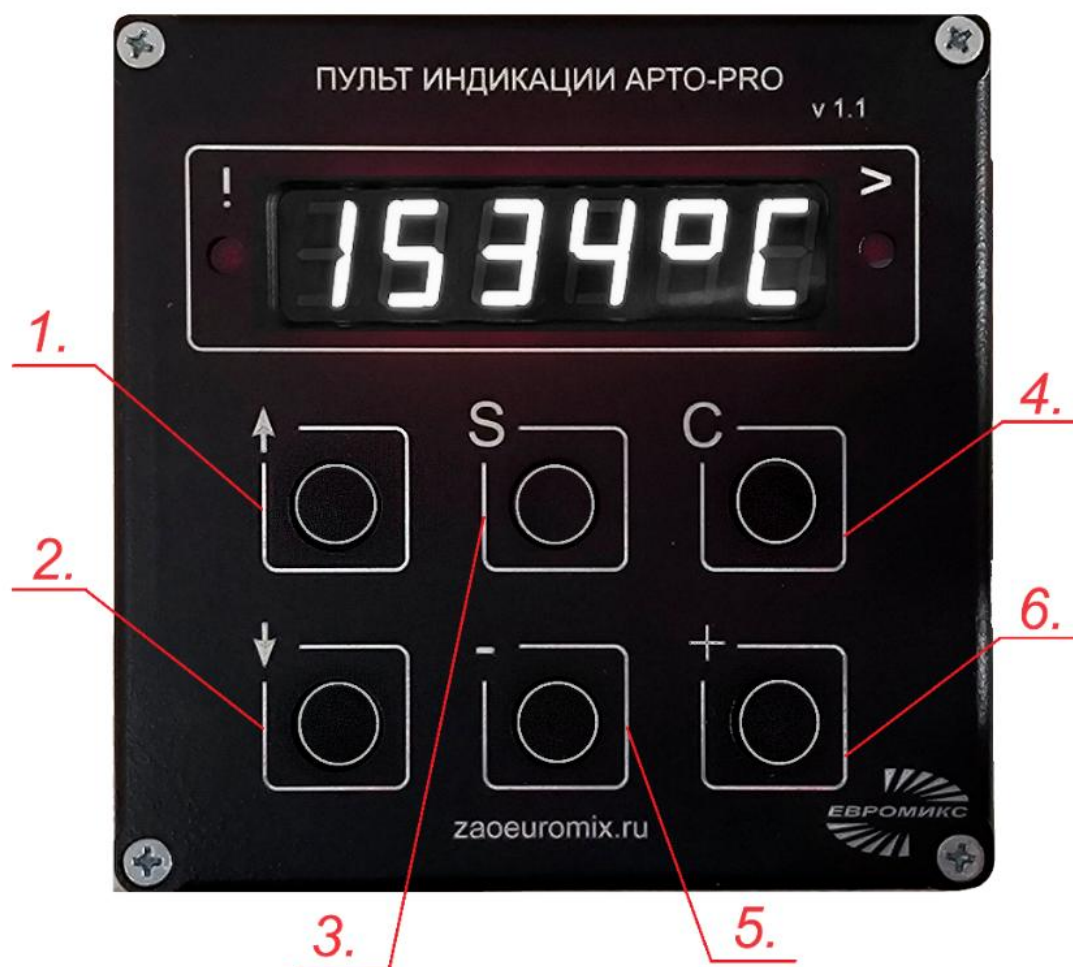
Рисунок 5 Клавиши клавиатуры: 1. Переход по меню вверх; 2. Переход по меню вниз; 3. Сохранить; 4. Отмена; 5. Уменьшение параметра; 6. Увеличение параметра
