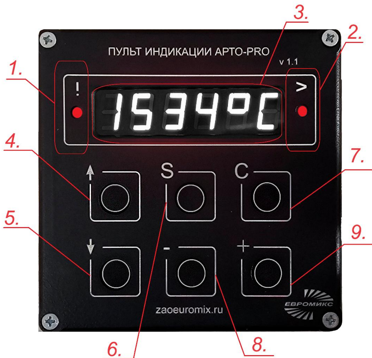
Рисунок 15 Пульт, передняя панель: 1. Светодиод сигнализации (“!”); 2.
