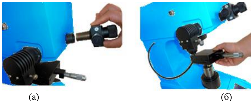
Рисунок 2.4 – Установка микрометра и предметного столика
