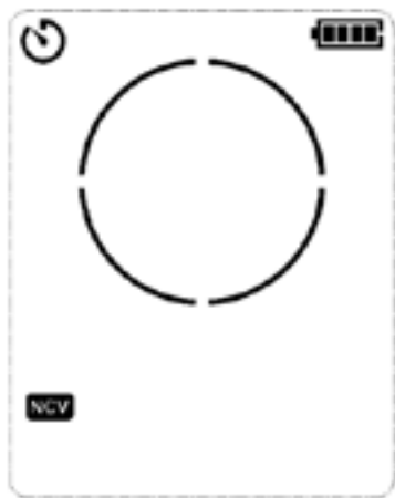
Рисунок 7.3а Напряжение не обнаружено в режиме NCV
