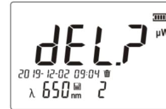
Затем коротко нажмите на кнопку  $\text{Enter}$  еще раз, чтобы удалить выбранные данные. Чтобы отменить удаление, коротко нажмите кнопку  $\text{Recall}$ . После завершения настроек нажмите кнопку  $\text{Enter}$ , чтобы выйти.
