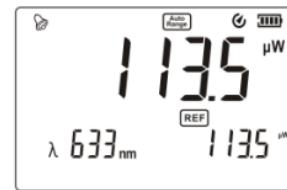
Короткое нажатие кнопки REL позволяет войти в режим относительного значения. В этом режиме относительное значение вычитается из фактического измеренного значения, а разница отображается в основной области дисплея, как показано на рисунке ниже:
