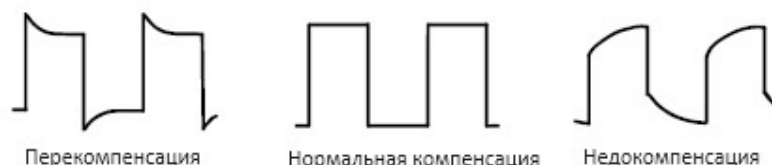
Рисунок 5.7 Компенсация щупа
