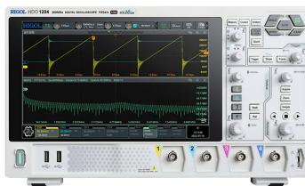
**Rigol HDO1104** – это цифровой 4-х канальный осциллограф высокого разрешения с полосой пропускания 100 МГц серии HDO1000.
