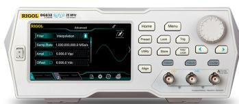
Генератор сигналов **DG822** поддерживает следующие функции: генератор функций, генератор сигналов произвольной формы, генератор шума, генератор импульсов, генератор кода, генератор гармоник, аналоговый / цифровой модулятор, частотометр и т.д.
