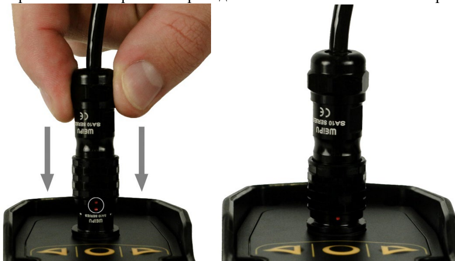
Рисунок 1 – Подключение провода заземления к блоку дефектоскопа
