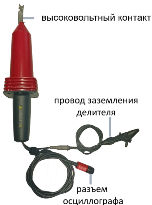
Рисунок 8 – Высоковольтный делитель напряжения HVP-39pro (PINTEK)
