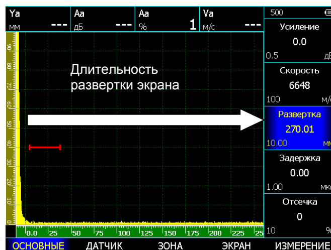
Рис. 2-11 Изменение длительности развертки
