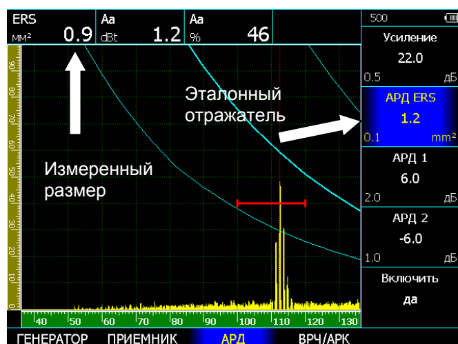
Рис. 6-3 Вычисление эквивалентной площади отражателя
