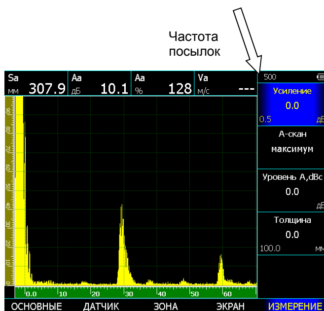
Рис. 2-9 Частота посылок на экране прибора
