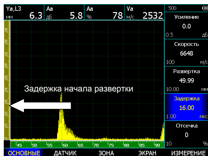
Рис. 2-12 Изменение задержки начала развертки
