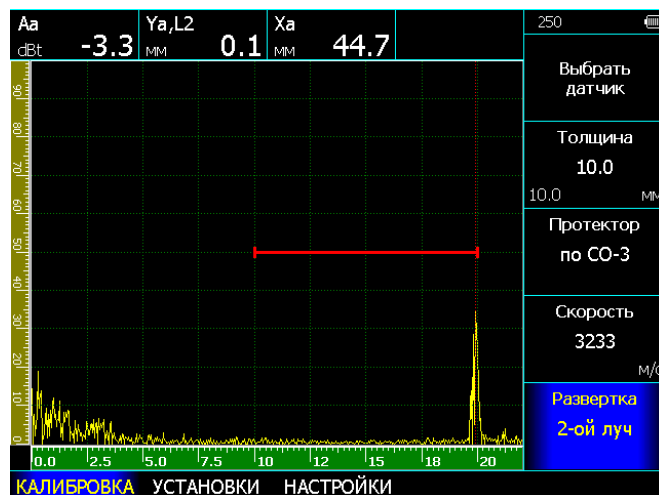
рис. 3-17 Результат автоматической калибровки ПЭП АН5070 на образце СОП-10-2х1 из стали 20
