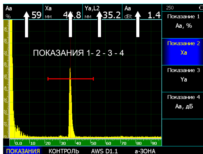
Рис. 3-2 Пример установки измеряемых величин
