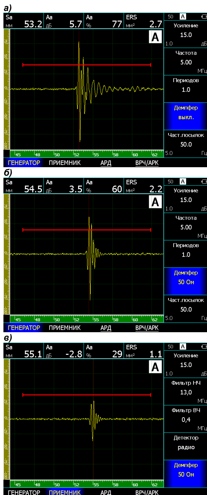
Рис. 2-8 Результат применения демпфирования на ПЭП 5 МГц
