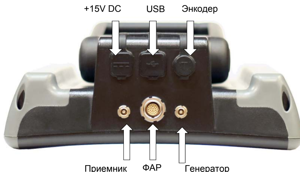
Рис. 1-5. Вид прибора сверху
