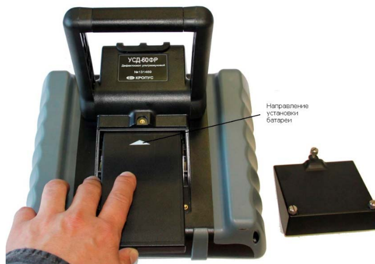
Рис. 1-4 Установка нового аккумулятора
