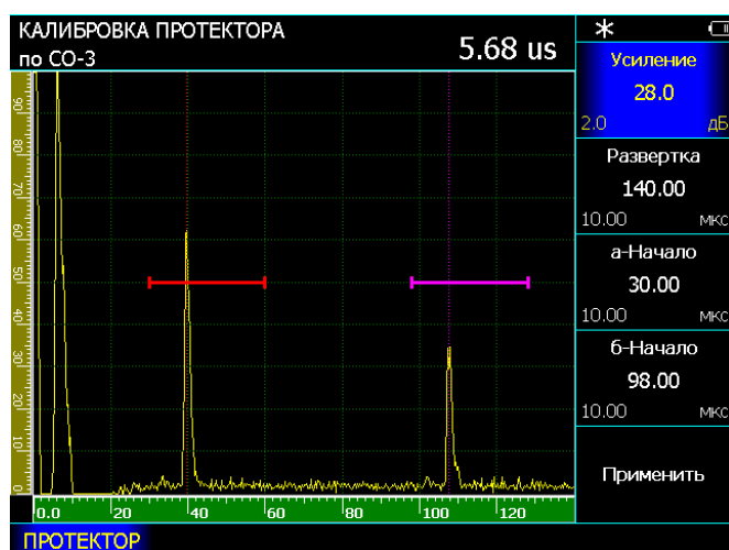
рис. 3-13 Калибровка наклонного преобразователя по образцу СО-3
