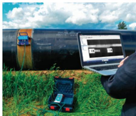
Разрешающая способность по эталону Duplex IQI EN 462-5 - 4 п.л./мм (130 мкм)
