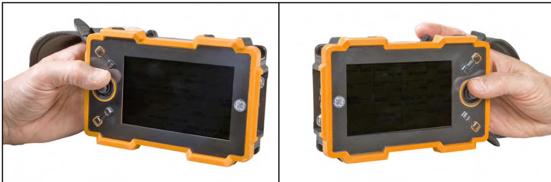
Рисунок 3. Расположение дефектоскопа USM Go для работы левой и правой рукой, соответственно
