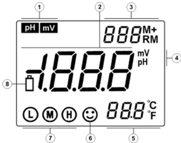
Рисунок 2 - Цифровой дисплей анализатора Altimax
