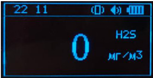
Рисунок 6 – Дисплей газоанализатора в «основном режиме работы»
