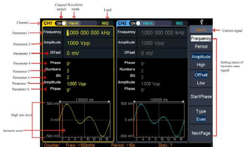
Рисунок 15 - Интерфейс задания настроек гармонической волны
