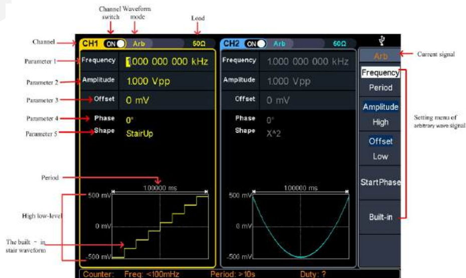
Рисунок 13 - Интерфейс задания настроек произвольной волны
