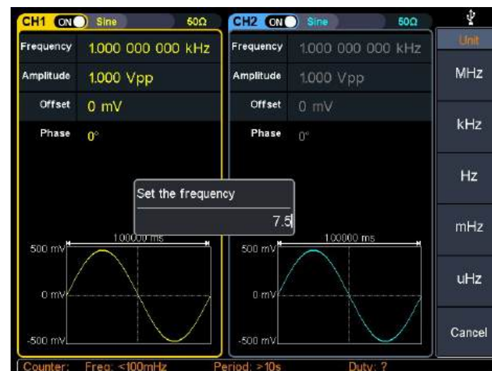
Рисунок 5 - Использование числового ввода для задания частоты
