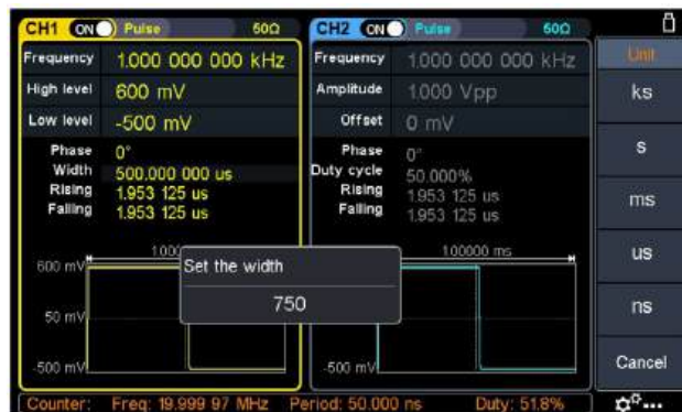
Рисунок 9 - Интерфейс настройки импульсной волны
