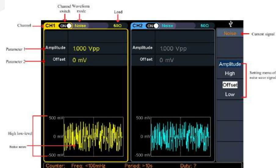
Рисунок 12 - Интерфейс задания настроек шумового сигнала
