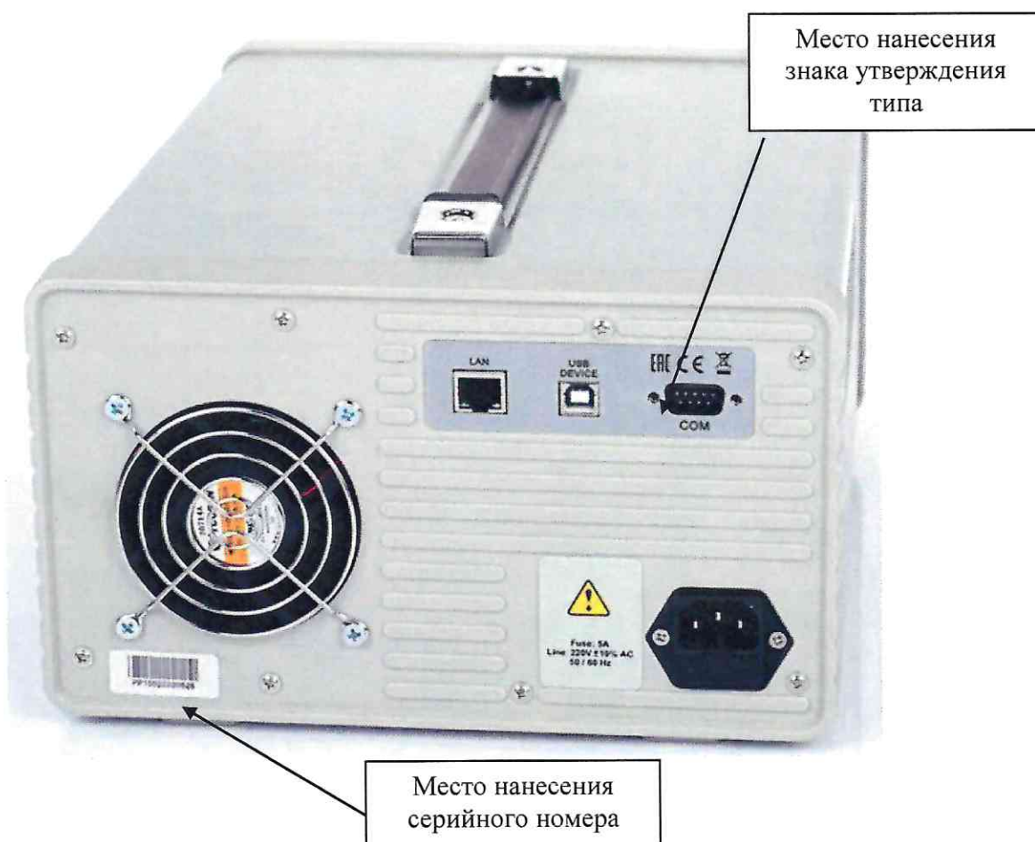
Рисунок 1 – Общий вид источников с указанием места нанесения знака утверждения типа, места нанесения серийного номера
