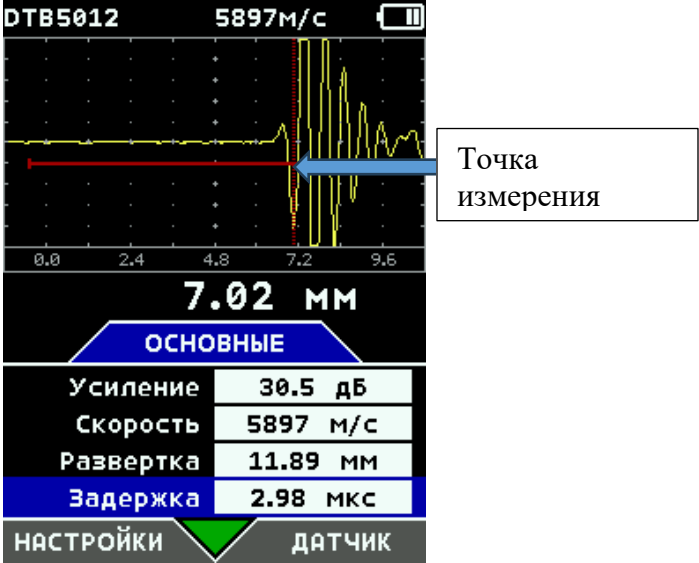
Рис.7-13 Принцип измерения времени прибором Диаскан-2М
