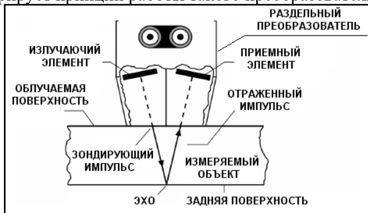
Рис. 5.6 Принцип работы р/с преобразователя
