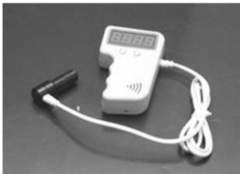
Рис. 1 Внешний вид денситометра
