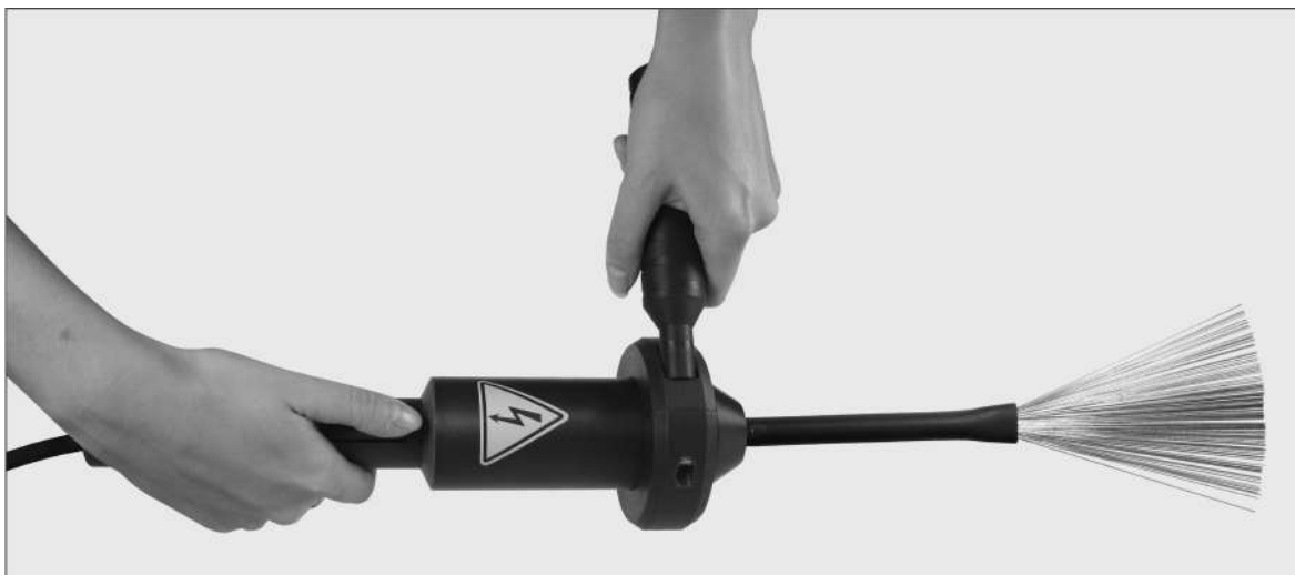
Рис. 25. Высоковольтный трансформатор - держатель с надетой съемной рукояткой.
