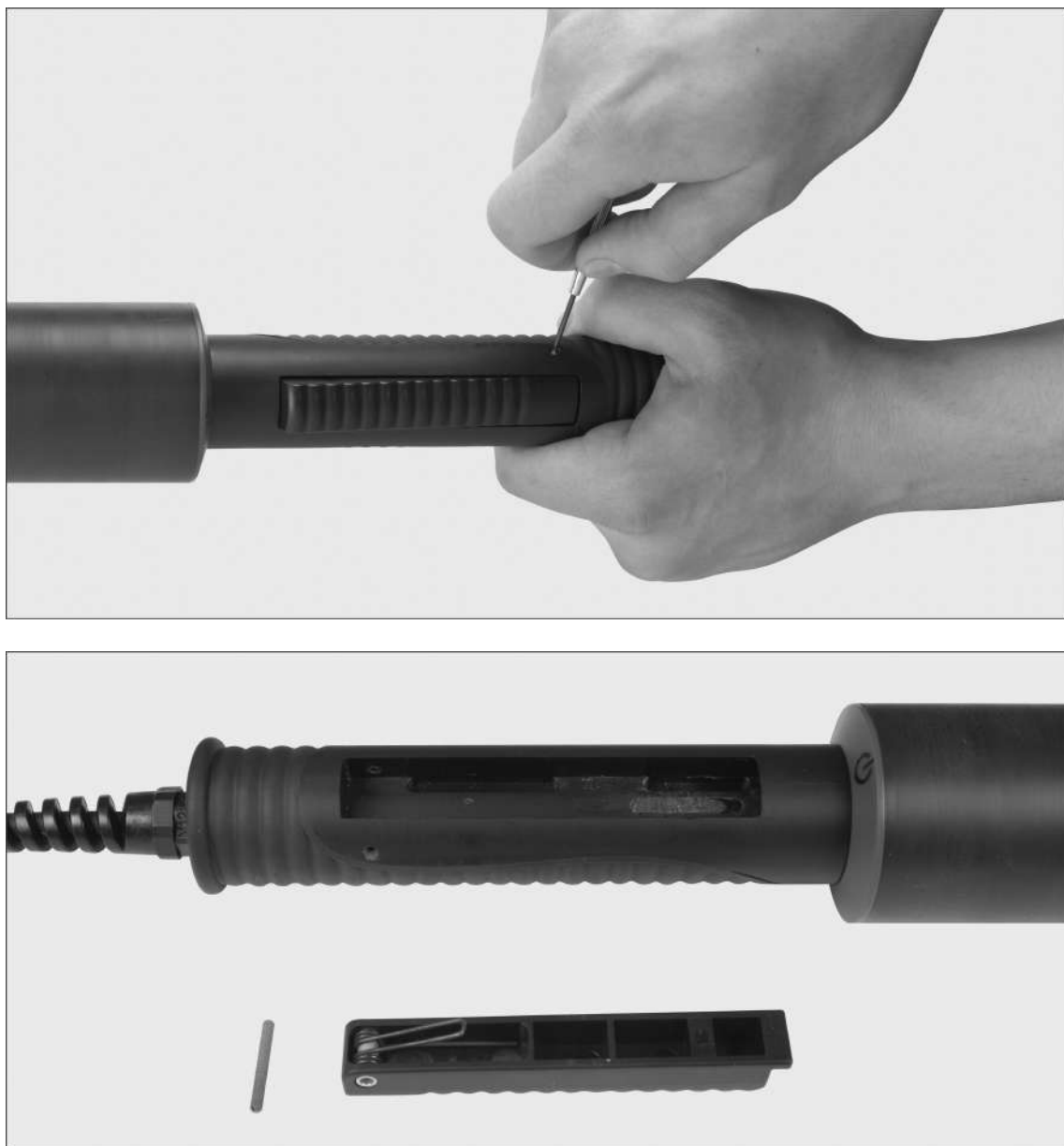
Рис.32. Последовательность действий при снятии кнопки включения: а) откручивание первого винта крепления кнопки; б) откручивание второго винта крепления кнопки; в) высоковольтный трансформатор-держатель со снятой кнопкой
