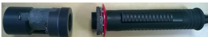
Рис.33. Вид высоковольтного трансформатора-держателя в разобранном виде: а) кожух; б) модуль в отсоединенном положении
