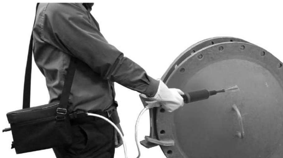
Рис. 22. Положение прибора при проведении контроля
