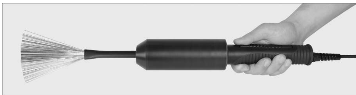
Рис. 21 Положение электрода, закрепленного в высоковольтном трансформаторе-держателе
