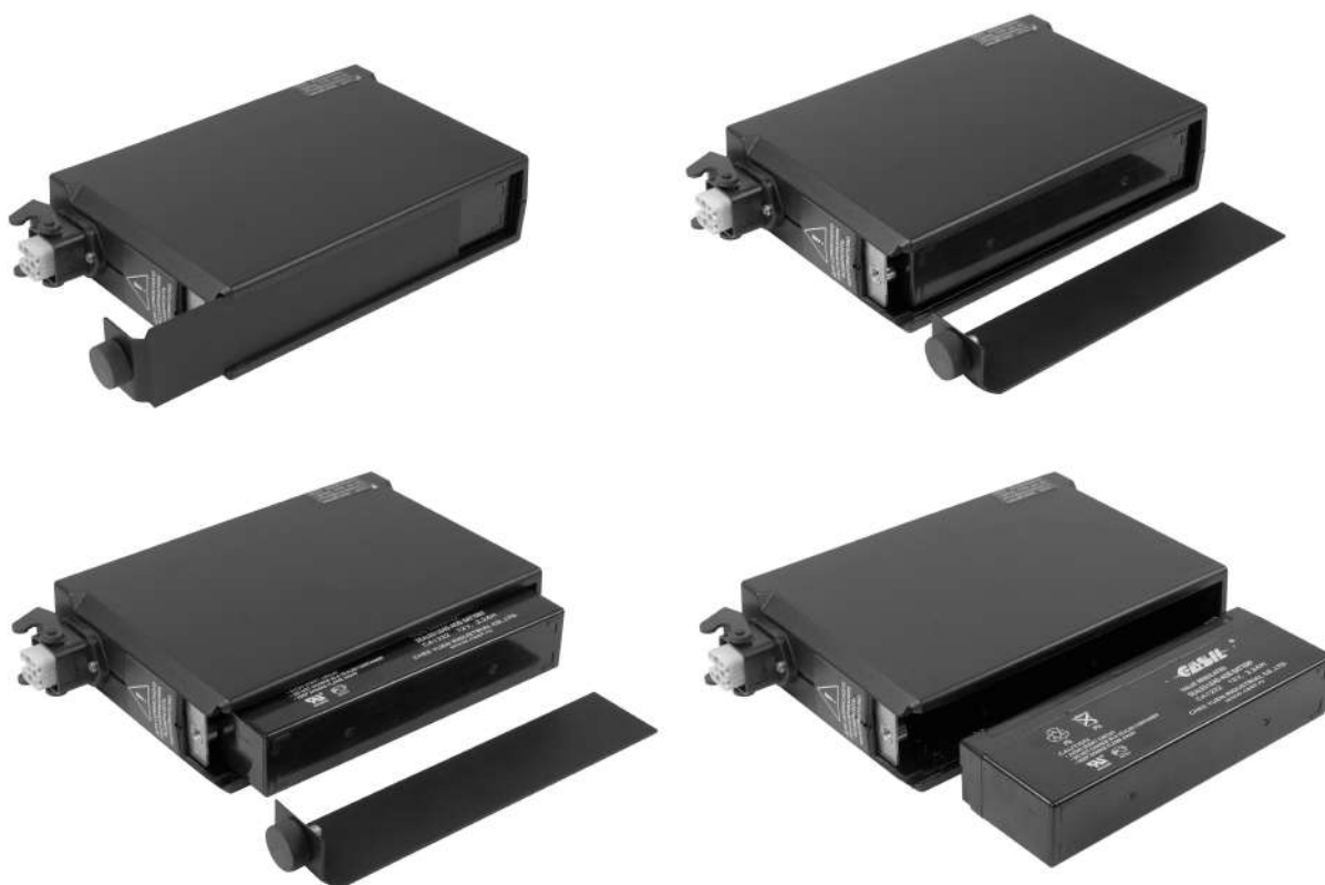
Рис. 31. Последовательность действий при замене аккумулятора
