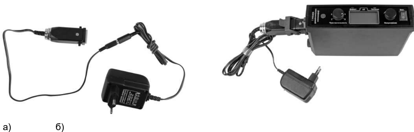
Рис. 29. Заряд аккумулятора в блоке контроля:
