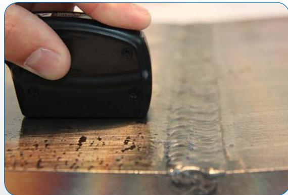
Конструкция антенных решеток допускает замену акустического модуля по мере истирания его рабочей поверхности.
