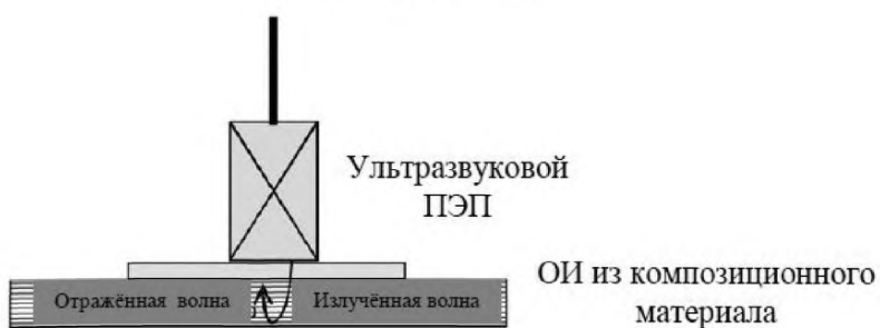
Рисунок 2 — Метод А. Ручной ультразвуковой эхо-импульсный метод
