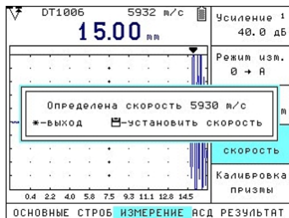
Измерение скорости распространения УЗК в образце
