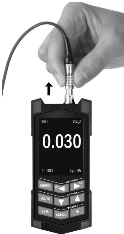
Рис. 2. Отсоединение преобразователя от электронного блока
