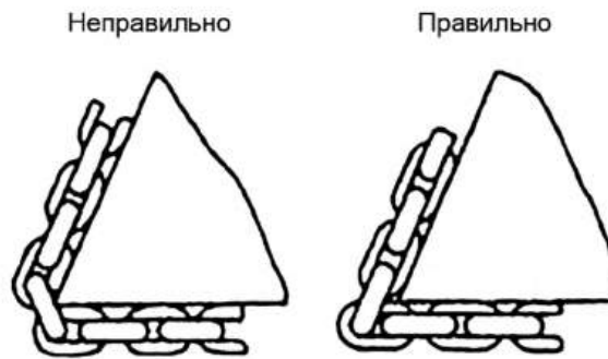
Рисунок 5 — Строповка грузов цепными стропами
