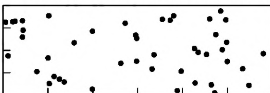
Рисунок А.5 — Процент пористости на поверхности: 3 %, 45 пор, d = 1 мм
