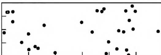
Рисунок А.3 — Процент пористости на поверхности: 2 %, 30 пор, d = 1 мм
