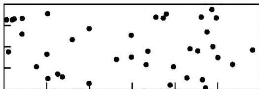
Рисунок А.4 — Процент пористости на поверхности: 2,5 %, 38 пор, d = 1 мм
