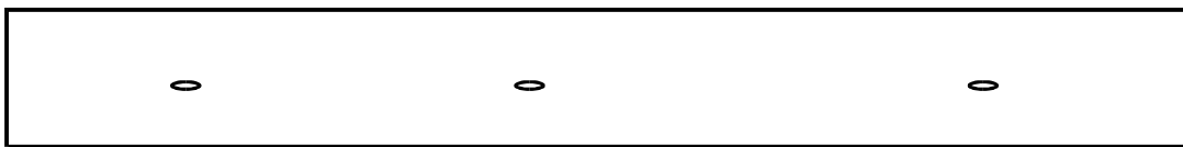
Пример 3 — три несплошности длиной по 3,2 мм
