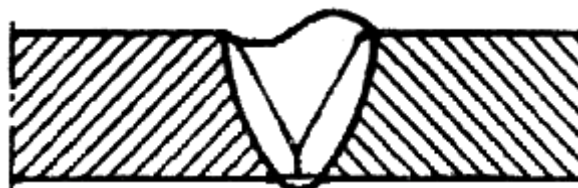
Рисунок ПА-49 - Неполностью заполненная разделка кромок
