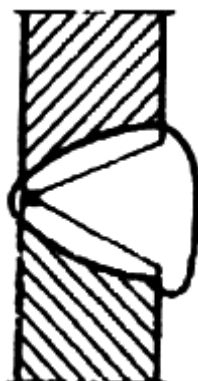
Рисунок ПА-46 - Наплыв (натек) в сварном соединении
