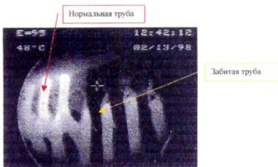
Рис.3.1 Термограмма труб поверхностей нагрева котла
