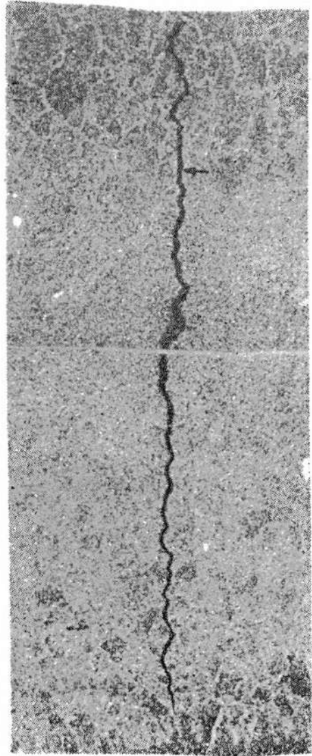
Рис. 24. Микротрещина в металле шва при автоматической дуговой сварке стали 10Г2ФР проволокой Св-08ГСМТ в газовой смеси \text{CO}_2 (85%) + \text{O}_2 (15%), травление в реактиве № 1 (см. табл. 2), 100 x
