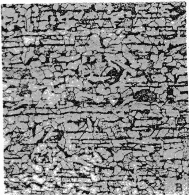
Рис. 61. Структура стали 09Г2С при ручной дуговой сварке: а — основной шов, электрод УОНИ 13/55, феррит, бейнит и перлит, б — подварочный шов, феррит, перлит и бейнит; в — основной металл, феррит и перлит, травление в реактиве № 1 (см. табл. 2), 100\times
