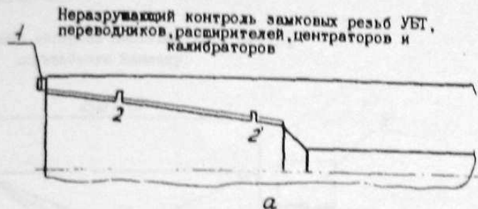
а Схема ультразвукового контроля замковых резб со стороны торцевых поверхностей муфт УБТ, переводников, расширителей, центраторов, калибраторов
