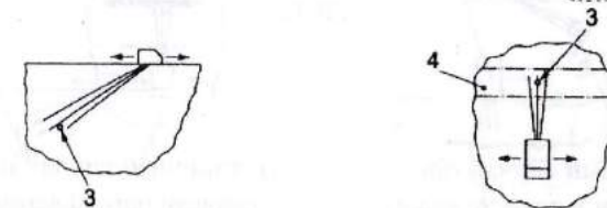
б) типичный случай при прохождении ультразвукового луча по толщине
