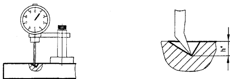
Рисунок Е.2 - Схема измерения глубины фрезерования сегмента
