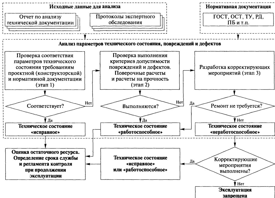
Рисунок 8.1 – Процедура оценки технического состояния сосуда
