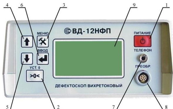
Рис. 3.2 Органы индикации и управления дефектоскопа ВД-12НФП
